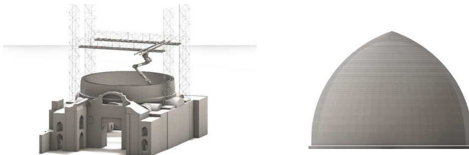
تصویر ۱۲: راست: گنبد نورگذر دوبسته ی به هم پیوسته؛ پوسته ی داخلی کاملاً فشاری و پوسته ی بیرونی از جغد چمانه. چپ: پرینت سه بعدی گنبد بر روی بنا توسط بازوی رباتیک (ترسیم: نگارنده)
