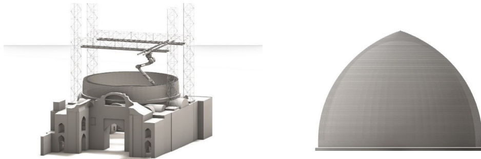
تصویر ۱۲: راست: گنبد نورگذر دوبوسته ی به هم پیوسته؛ پوسته ی داخلی کاملاً فشاری و پوسته ی بیرونی از جفد چمانه. چپ: پرینت سه بعدی گنبد بر روی بنا توسط بازوی رباتیک (ترسیم: نگارنده)
